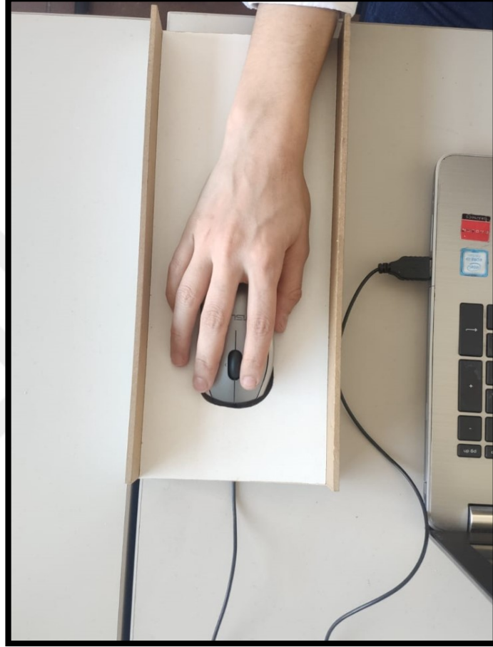
Şekil 5.1: PVT prosedüründe katılımcıların kullandıkları fare ve farenin sabitleme aparatı ve farenin kullanılma biçimi. Aparatın yanında bulunan bilgisayar katılımcıya komutların aktarılmasını ve görsel geri bildirimi sağlamaktadır.
