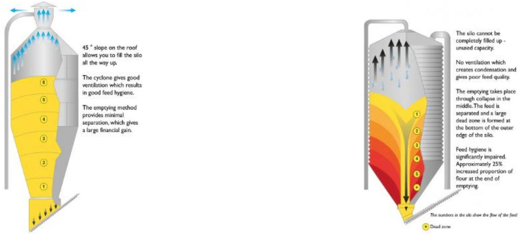
Şekil 3.2. Kütlesel akım ve çekirdek akımının karşılaştırılması
