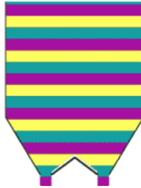
Şekil 3.5. Akım köprüsü oluşumu
