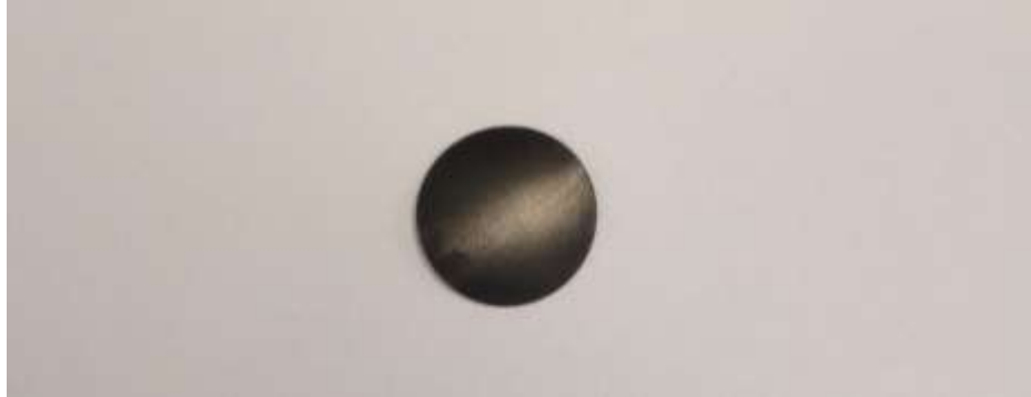
Fotoğraf 2.2. Uygun boyutta kesilmiş bir katot diski
