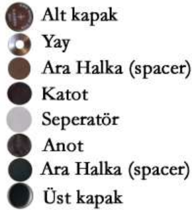
Şekil 2.2. Pil üretiminde sırasıyla kullanılan bileşenler
