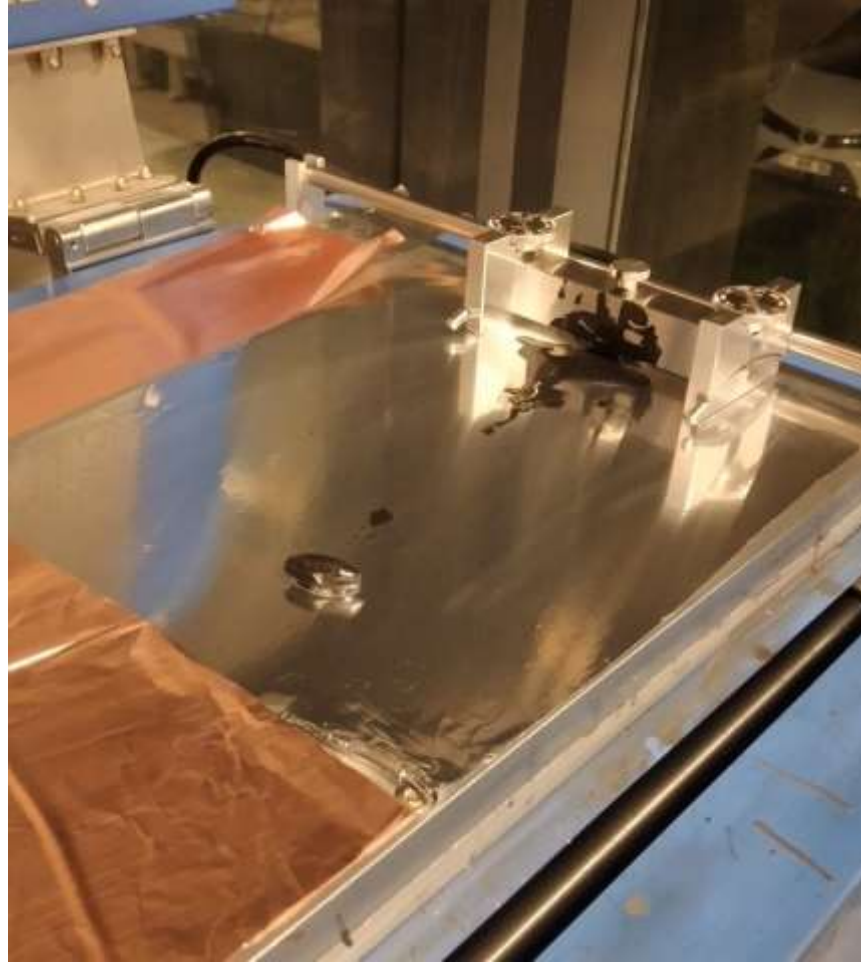
Fotoğraf 2.1. Doctor Blade yöntemi ile katot sıvama işlemi
