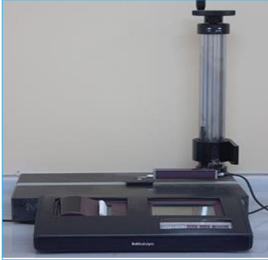
Resim 3.3. Yüzey pürüzlülük cihazı ve yüzey pürüzlülüğün ölçülmesi
