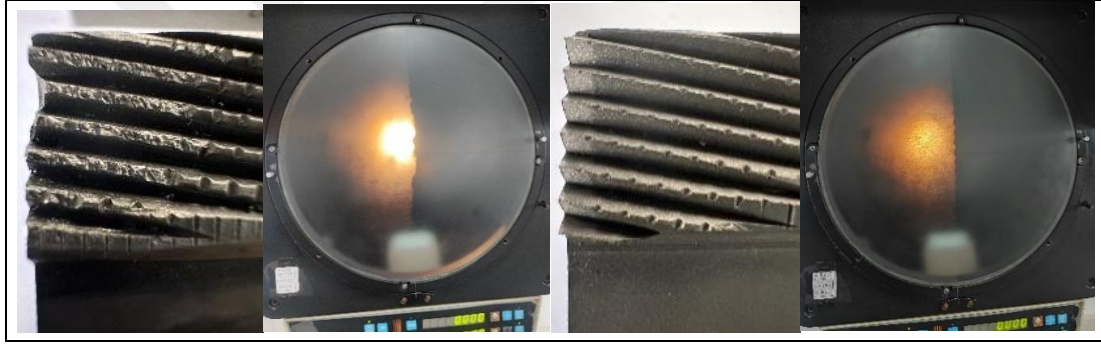
Resim 3.1. Deforme olmuş (sol) ve sağlam kalıp (sağ) optik projektör ile görünümü
