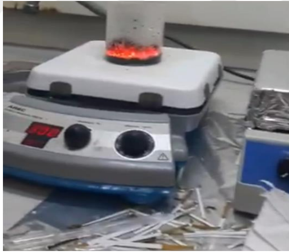
Şekil 3.9. Çözeltinin sinterlenmesi (jel oluşumu) (Ç.Ü Süperiletkenlik ve Manyetizma Lab).
