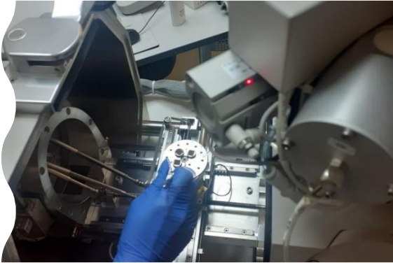
Şekil 3.12. Toz numunelerinin iletkenliğinin sağlanması için altın kaplama kabı (sağ) ve SEM cihazına yerleştirilen numuneler (sol)
