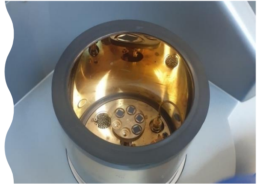
Şekil 3.12. Toz numunelerinin iletkenliğinin sağlanması için altın kaplama kabı (sağ) ve SEM cihazına yerleştirilen numuneler (sol)
