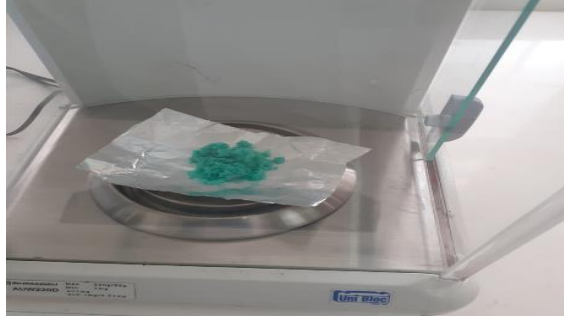
Şekil 3.7. Nitratlı bileşiklerin hassas terazide tartılması (Ç.Ü Süperiletkenlik ve Manyetizma Lab)
