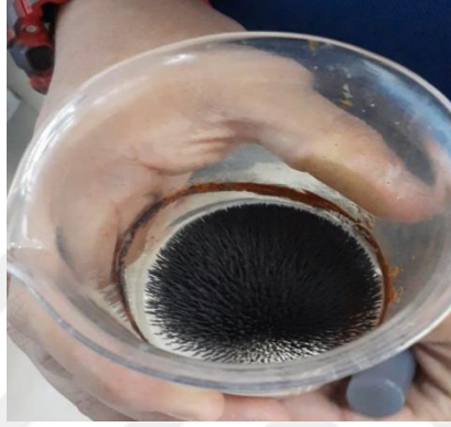
Şekil 3.11. Beher içerisinde toplanan manyetik NP'lerin beher altında tutulan mıknatıs ile etkileşimi.
