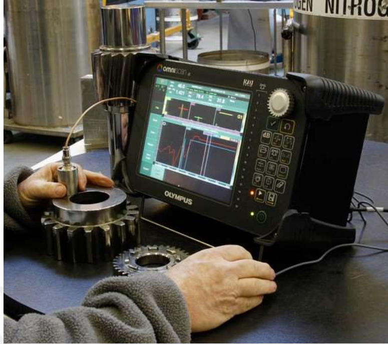
Şekil 2.7. Ultrasonik analiz uygulanan bir motor dişlisi (www.awacosmetics.com)
