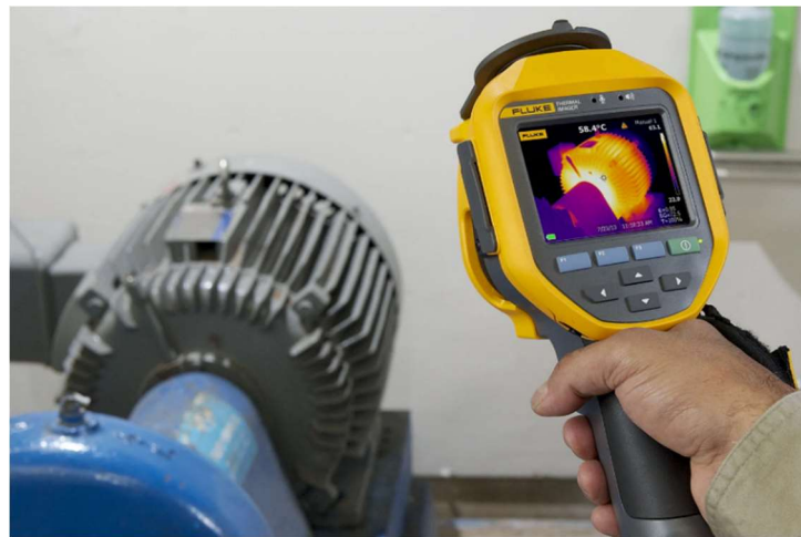
Şekil 2.8. Termal resimleme ile muayene edilen bir motor (www.stendustri.com.tr)
