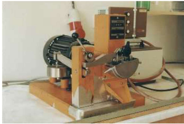
Şekil 2.15. Vesela vd. yağın fiziko-kimyasal özelliklerinin yağlayıcılığa etkisini ölçtükleri düzenek
