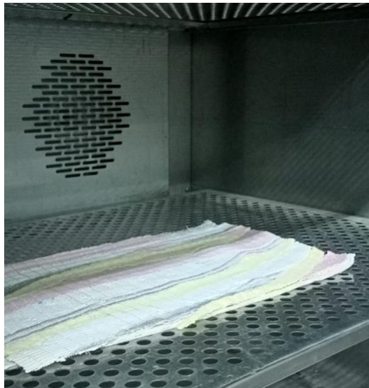
Resim 6.16. Numunenin Etüv Cihazında Bekletilmesi
