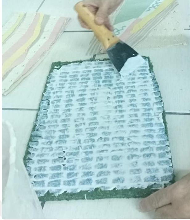
Resim 6.12. Numune Yüzeyine Yapıştırma Malzemesi Sürülmesi
