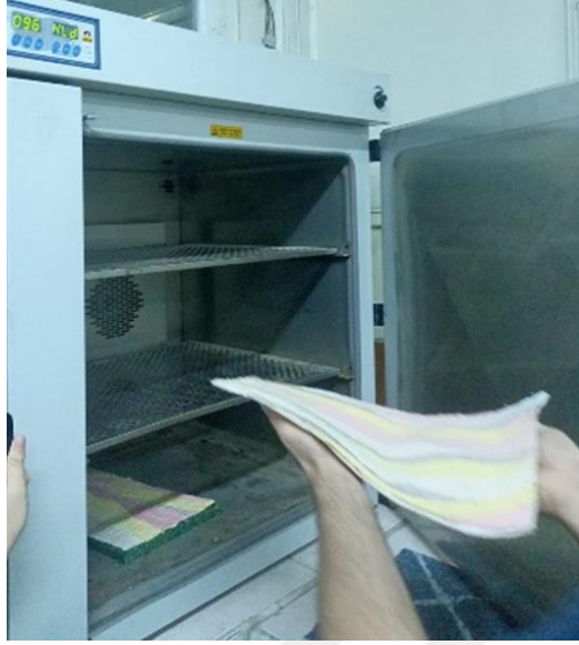
Resim 6.14. Numunenin Etüv Cihazına Konulması
