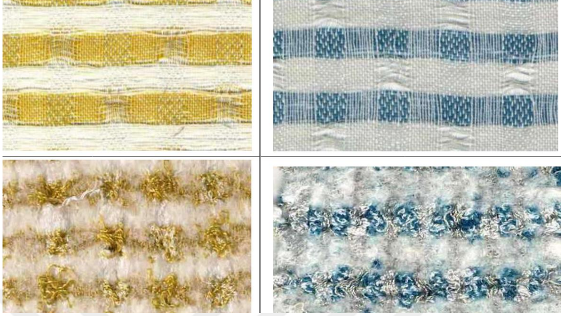
Resim 7.7. Bezayağı, petek örgüsü ve Türk sateni tekniği ile dokunmuş kumaşların keçeleşme öncesi ve sonrası (Acar, 2010:133).
