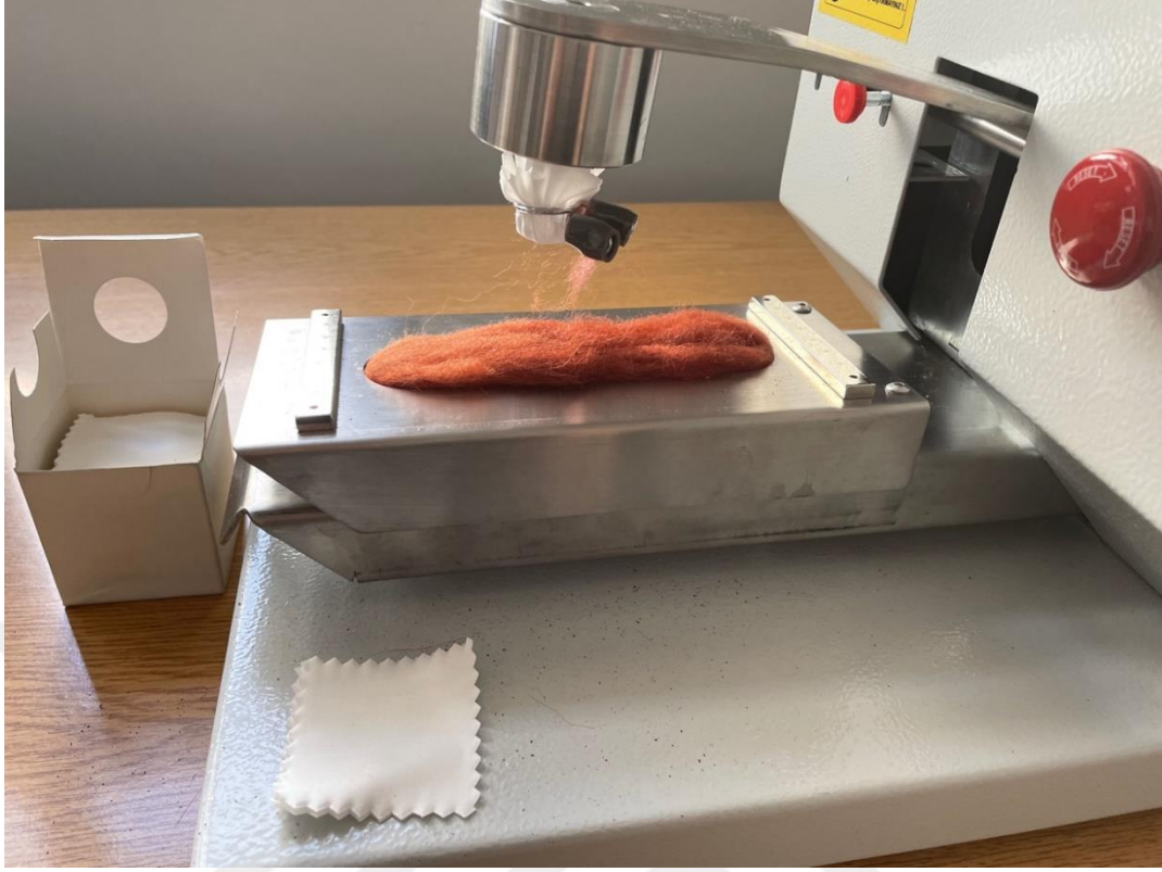
Resim 6.5. Sürtünme haslığı tayini (Kemer Gürsoy, 2023).
