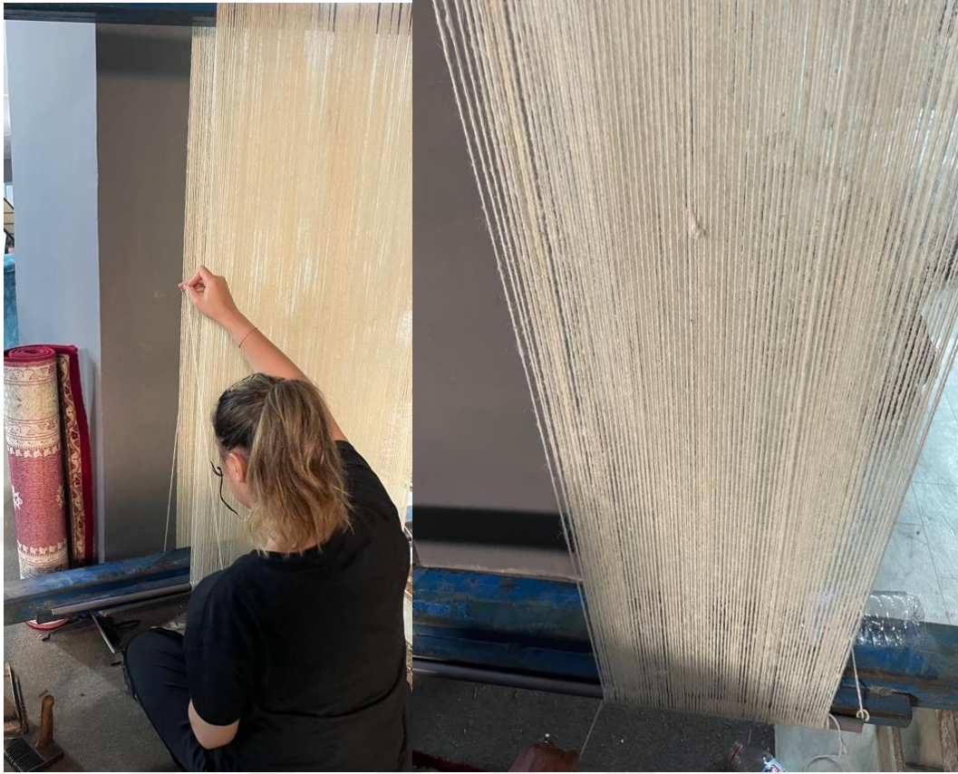
Resim 8.22. Germe tezgâhta çözgü hazırlama işlemi (Kemer Gürsoy, 2023).
