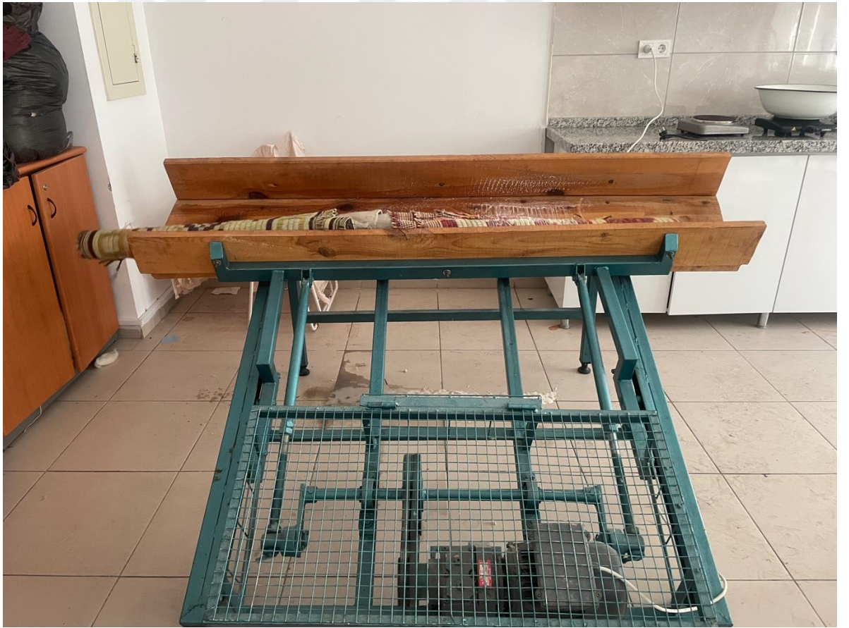
Resim 8.32. Keçe tepme makinesinde keçeleştirme işlemi (Kemer Gürsoy, 2023).
