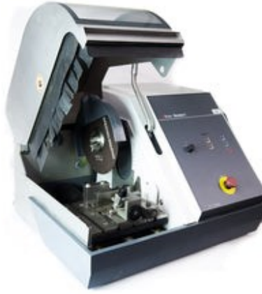
Şekil 4.1. Struers Discotom 5 kesme cihazı
