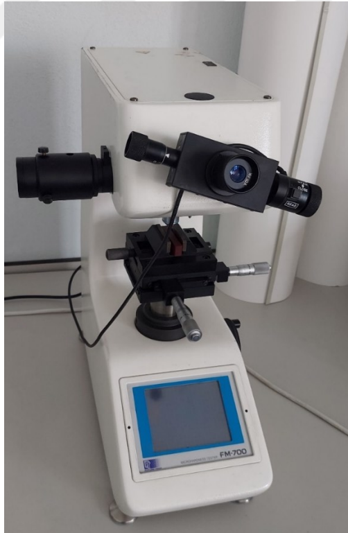
Şekil 4.6. Future-Tech FM-700 mikrosertlik cihazı
