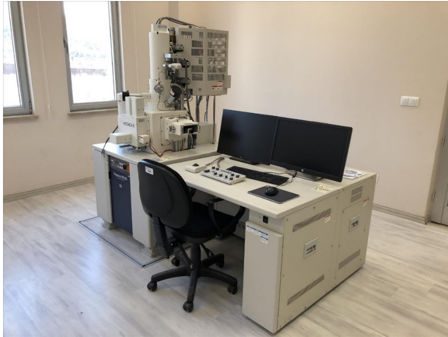
Şekil 4.5. Hitachi Regulus 8230 marka SEM cihazı.
