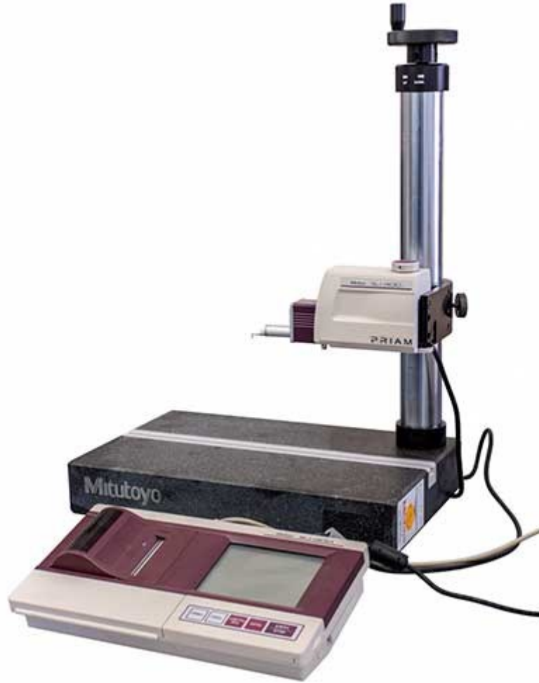
Şekil 4.8. Mitutoyo SJ-400 yüzey profil ölçüm cihazı
