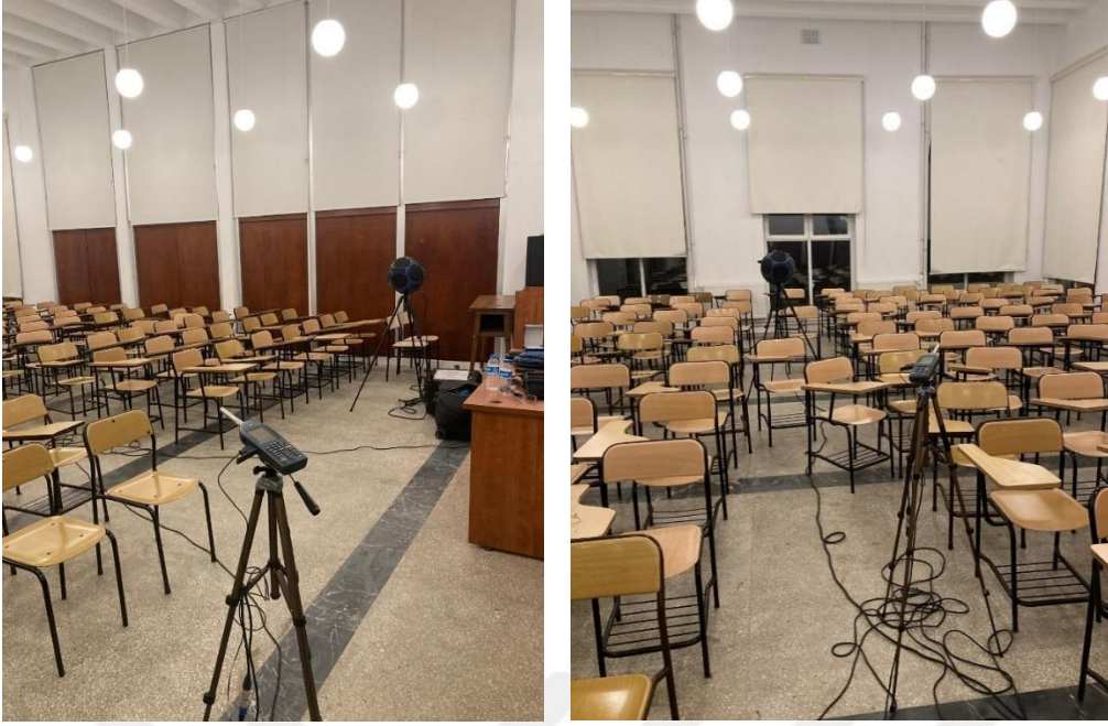
Şekil 4. 81 Ernst Egli Konferans Salonu - Yansışım Süresi Ölçüm Fotoğrafları (S1-R4 ve S2-R3)
