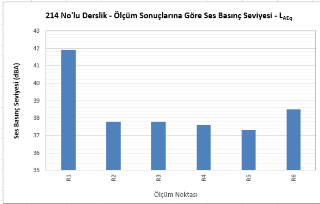
Şekil 4. 3 Derslik 214 - Ses Basınç Seviyesi Ölçüm Sonuçları
