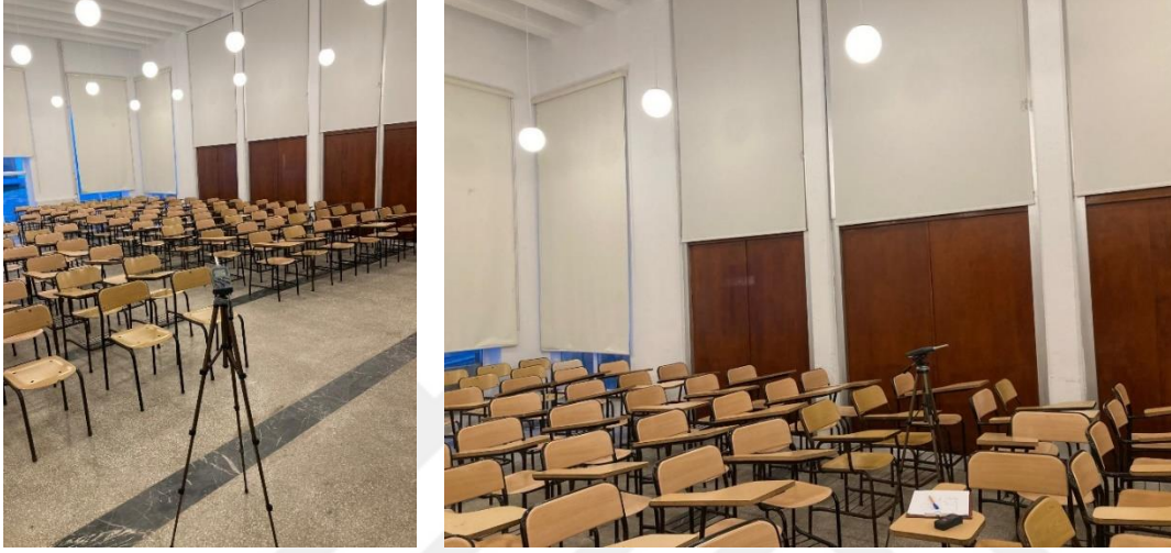
Şekil 4. 79 Ernst Egli Konferans Salonu - Arka Plan Gürültüsü Ölçüm Fotoğrafları (R4 ve R5)
