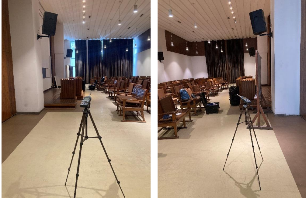
Şekil 4. 93 Misak-1 Millî Konferans Salonu - Arka Plan Gürültüsü Ölçüm Fotoğrafları (R1 ve R9)
