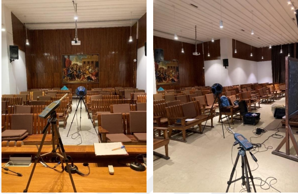
Şekil 4. 95 Misak-ı Millî Konferans Salonu - Yansışım Süresi Ölçüm Fotoğrafları (S2-R6 ve S1-R9)
