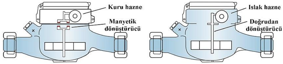
Şekil 2.12. Kuru hazneli ve ıslak hazneli su sayacı (Van Zyl 2011)
