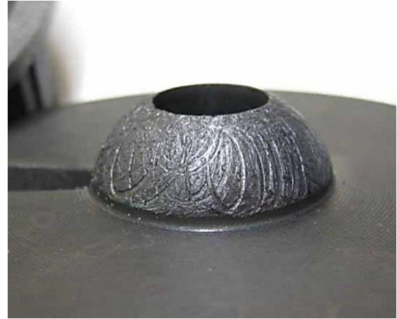
Şekil 2.17. Kum ve askıda katı maddelerin; a) Pistona verdiği zarar; b) Diske verdiği zarar (Barfuss vd. 2011)
