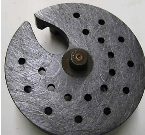
Şekil 2.17. Kum ve askıda katı maddelerin; a) Pistona verdiği zarar; b) Diske verdiği zarar (Barfuss vd. 2011)
