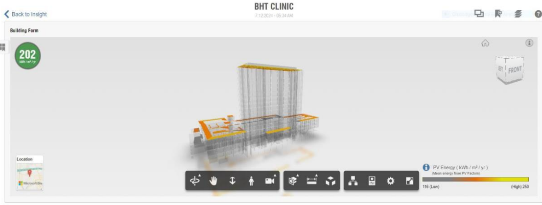
Resim 24 Revit Model Enerji Kullanım Yoğunluğu Autodesk Insight verileri Bina konumuna ve cephesine bağlı olarak gün ışığını etkin kullanmaktadır.
