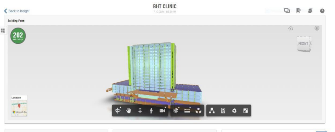
Resim 23 Bina performans analizi için oluşturulan enerji modeli Autodesk Insight verileri
