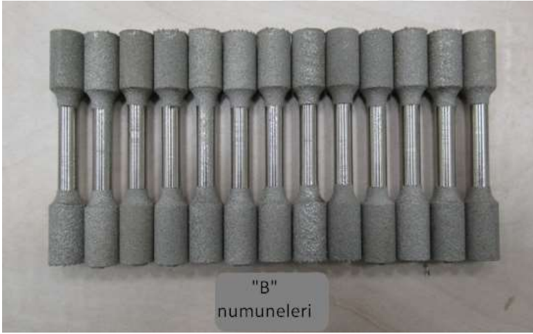
Şekil 4.7 EBM Yöntemi ile Üretilen Çekme Bölgelerinden Talaş Kaldırılan Numuneler
