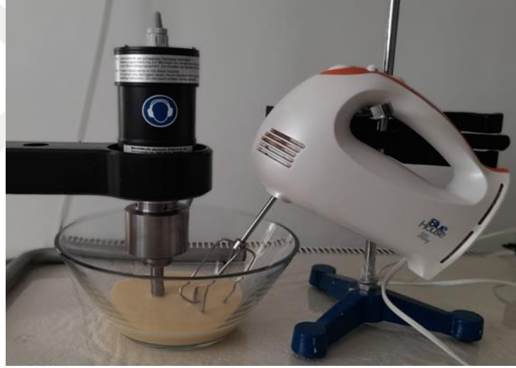
Şekil 3.1: Kek hamuruna ultrason uygulama.
