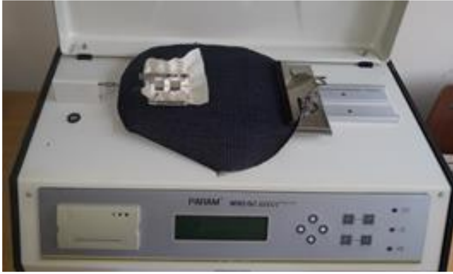
Şekil 3.11. Sürtünme katsayısı test cihazı (Labthink Param MXD-02)
