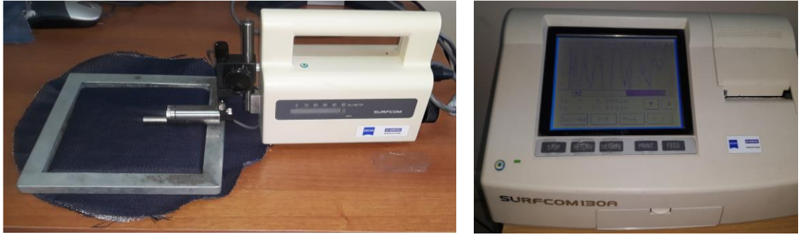
Şekil 3.10. Yüzey Pürüzlülük Test Cihazı (Surfcom 130 A)
