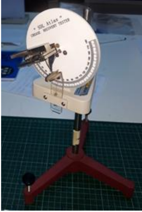
Şekil 3.5. Katlanma Geri Dönüşüm Test Cihazı (SDL Atlas)
