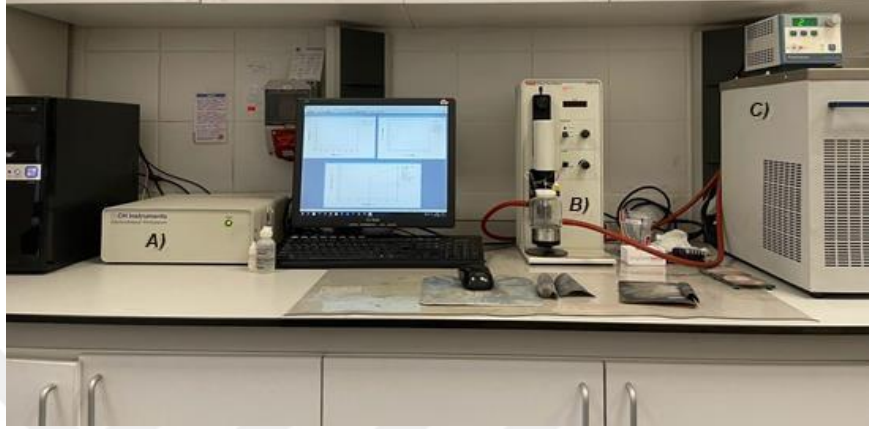
Şekil 3.3 Laboratuvar ortamında kurulan elektrokimyasal deney sistemi A) CHI 660 B Potansiyostat/Galvanostat B) RD-2 Döner Disk Elektrot C) PolyScience Termostat, Model 9106, USA
