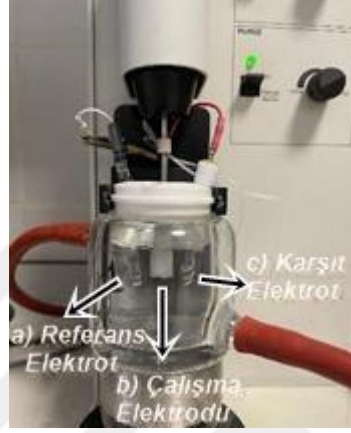
Şekil 3.4 Korozyon Hücresi a) Referans Elektrot (Ag/AgCl) b) Çalışma Elektrodu (NiCrMo, CoCrMo, c) Karşıt Elektrot (Pt)
