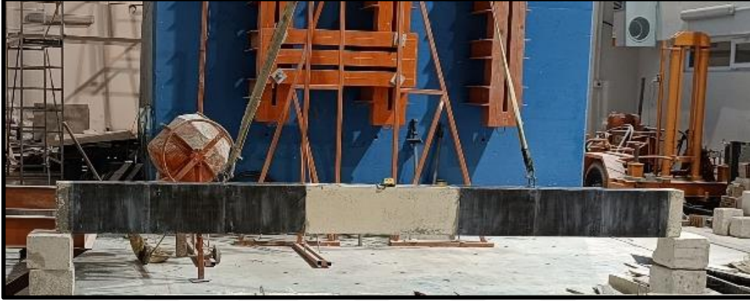
Resim 5.11. N-3 numaralı kirişin BFRP sargılaması sonucu nihai hali
