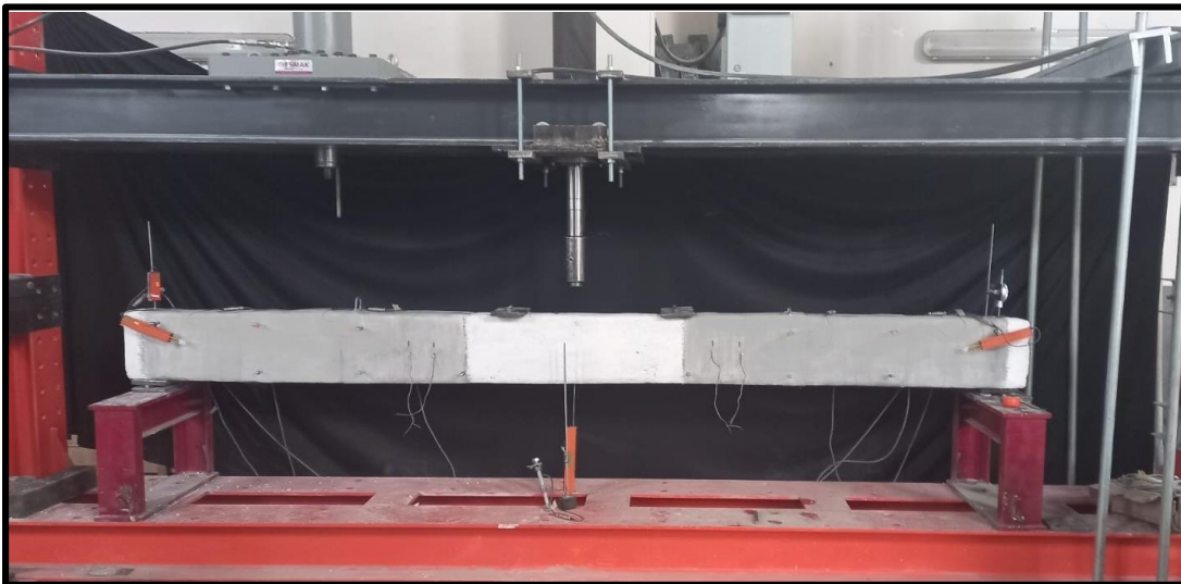
Resim 5.14. N-6 numaralı kirişin PET-FRP sargılaması sonucu nihai hali
