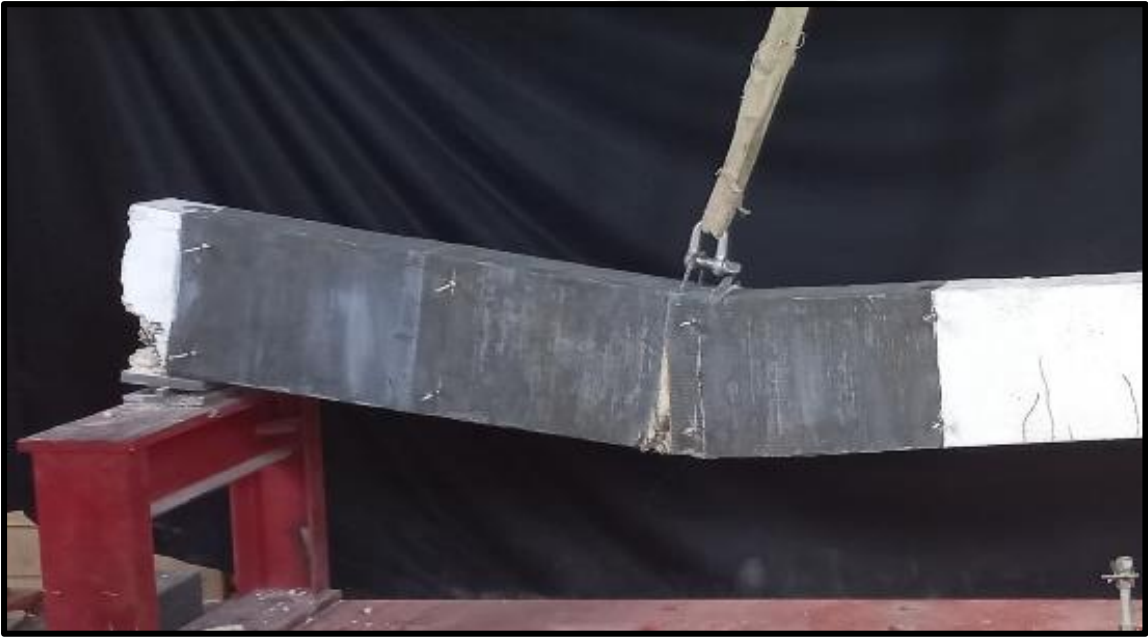
Resim 6.11. Deney sonrası kirişte oluşan deformasyonlar
