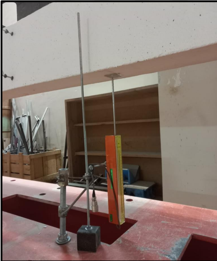
Resim 6.2. Kiriş açıklık ortasına yerleştirilen LVDT
