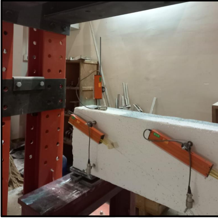
Resim 6.1. Mesnet ve kiriş yüzeyine yerleştirilen LVDT' ler
