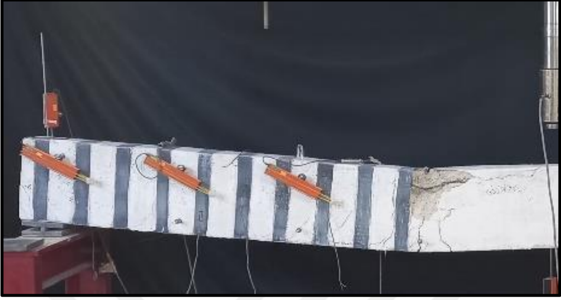
Resim 6.16. Deney sonrası kirişte oluşan deformasyonlar
