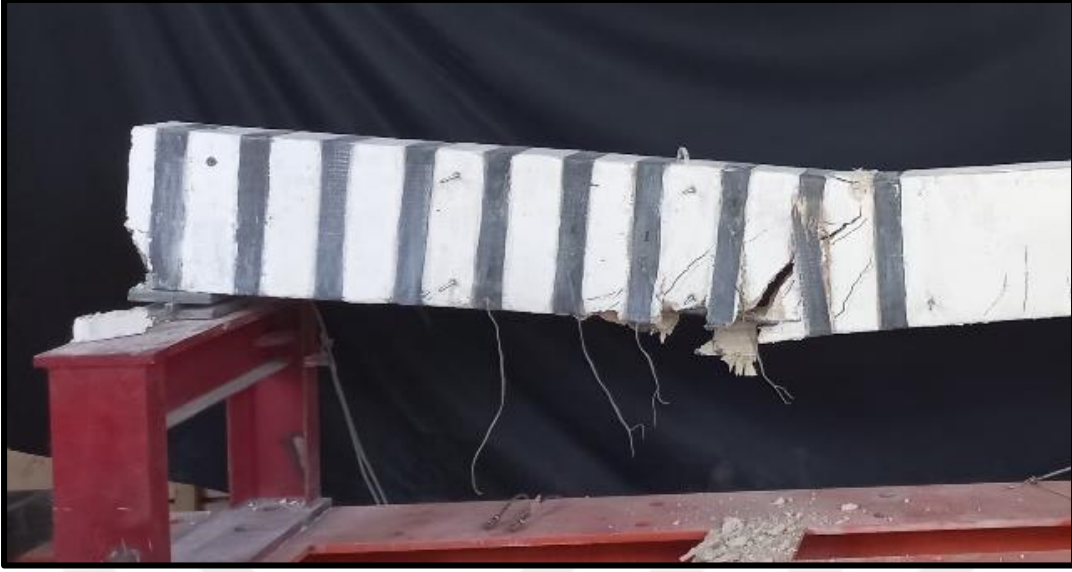
Resim 6.19. Kirişte oluşan deformasyonların nihai hali
