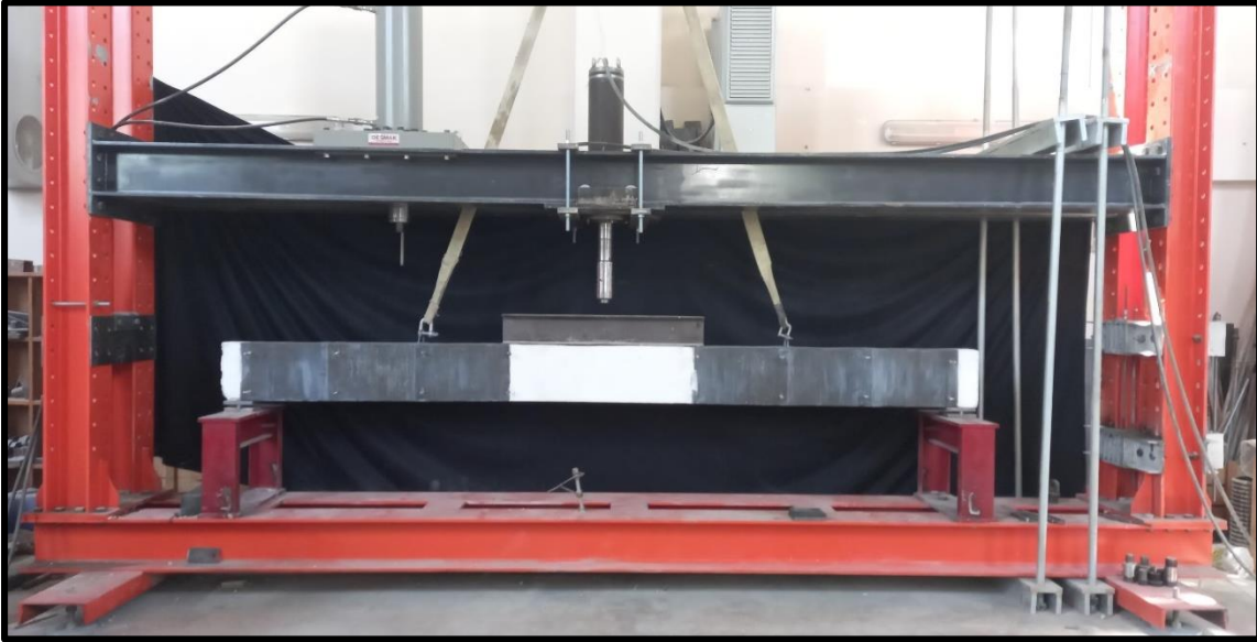
Resim 5.10. N-2 numaralı kirişin CFRP sargılaması sonucu nihai hali
