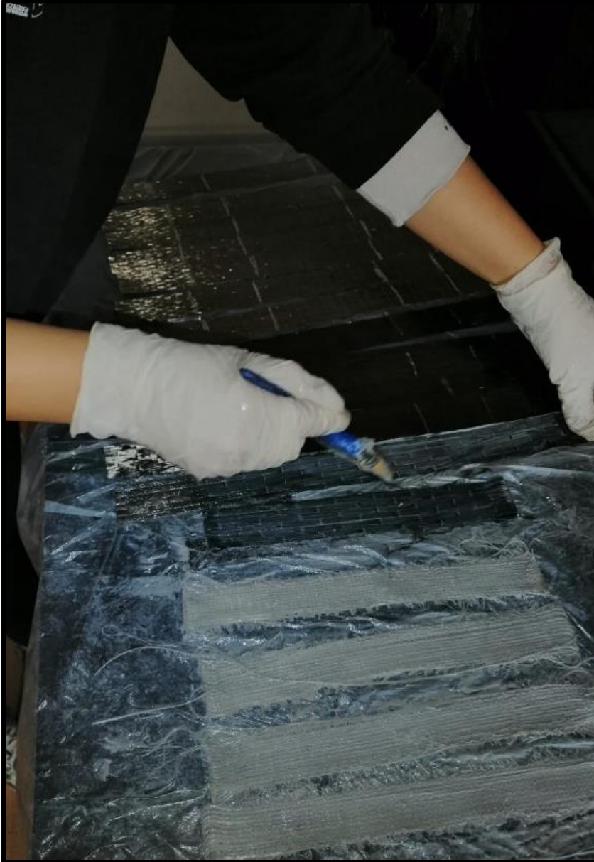
Resim 5.1. Kupon elemanların her iki yüzeyine epoksi uygulanması
