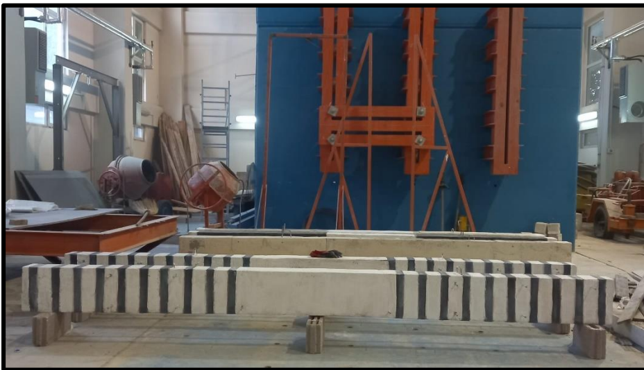
Resim 5.12. N-4 numaralı kirişin CFRP sargılaması sonucu nihai hali
