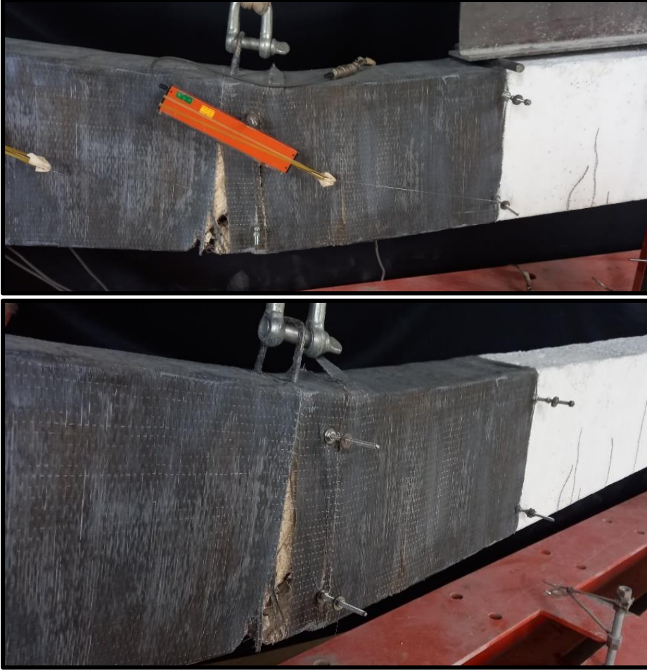
Resim 6.12. Kirişte oluşan deformasyonların nihai hali
