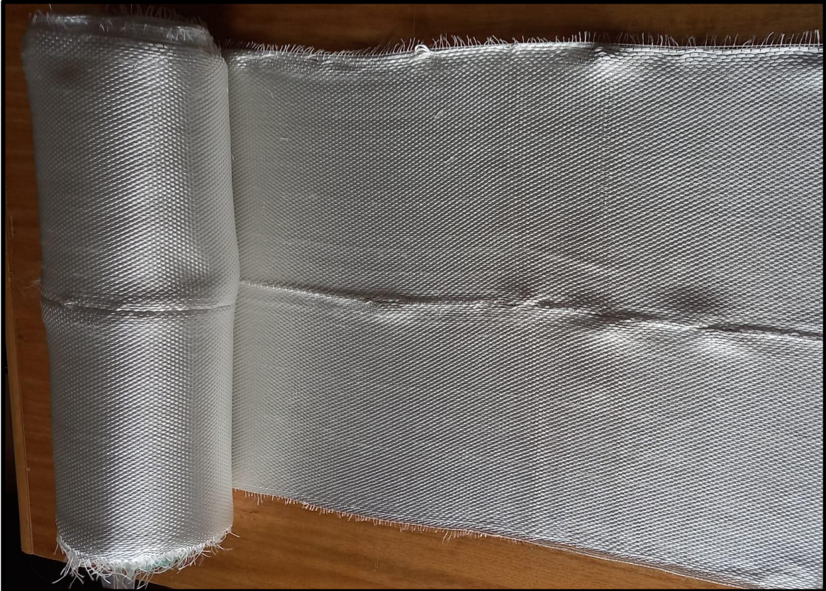
Resim 3.3. Deneysel çalışmada kullanılan PET-FRP malzeme
