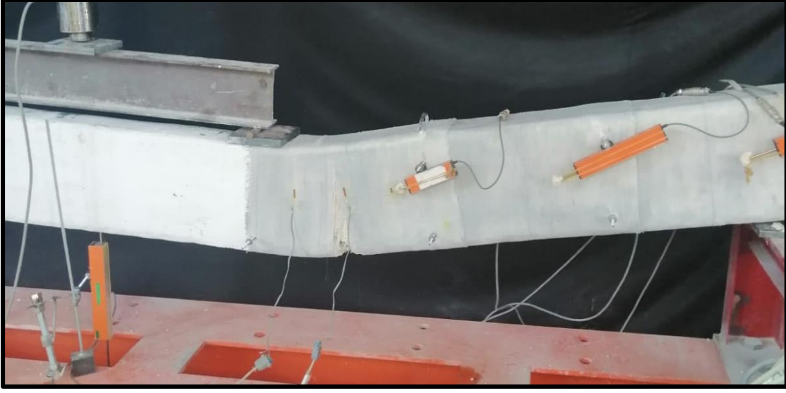
Resim 6.24. Kirişte oluşan deformasyonların nihai hali
