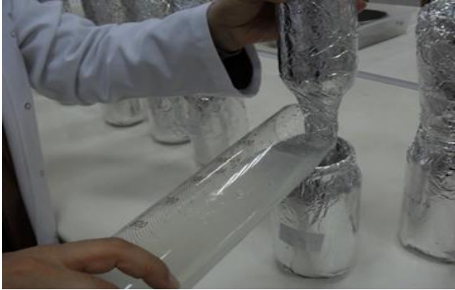
Resim 3.4 Leonard kavanoz sistemi ve hazırlanması
