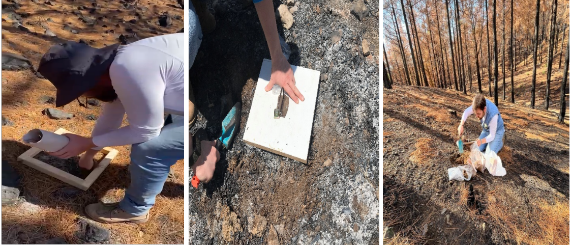
Şekil 2.7. Ağustos 2021 yılında çıkan Aydıncık yangınında sahadan besin kaybını belirlemek için ibre, kül ve toprak örnekleme.
