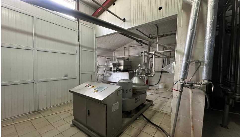
Şekil.3.2. Seperatöre ait görsel
