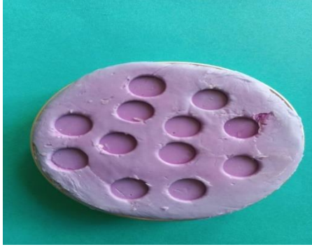
Şekil 3. Mum örneklerin hazırlanması için kullanılan silikon kalıp
