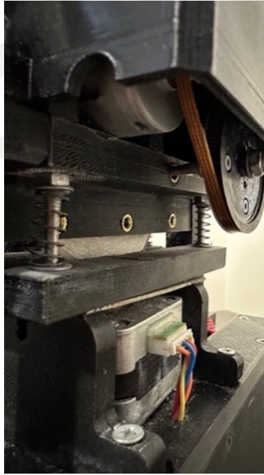
Şekil 4.14 : Kesme sisteminde DA motor ile kumaş kesme bıçağı.
