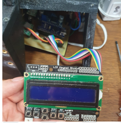
Şekil 3.18 : LCD ekranın ve Shield’in devre bağlantısı.
