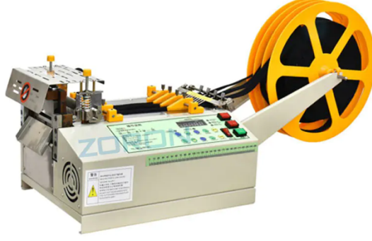
Şekil 2.6 : 140C fermuar kesme makinesi.
