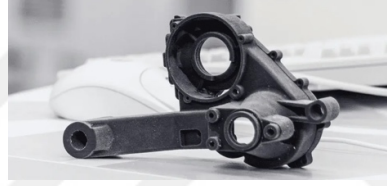
Şekil 1.11 : Polyjet 3B baskı teknolojisi ile üretilmiş parça.
