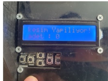
Şekil 3.27 : Kesilen fermuar sayısının gösterilmesi.
