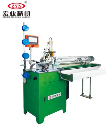
Şekil 2.4 : HY-134K-C plastik fermuar kesme makinesi.
