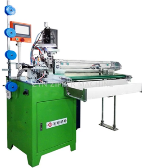
Şekil 2.5 : HY-134B-C metal fermuar kesme makinesi.
