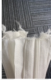
Şekil 5.1 : Kesim sonrası saçaklanmış fermuarlar.
