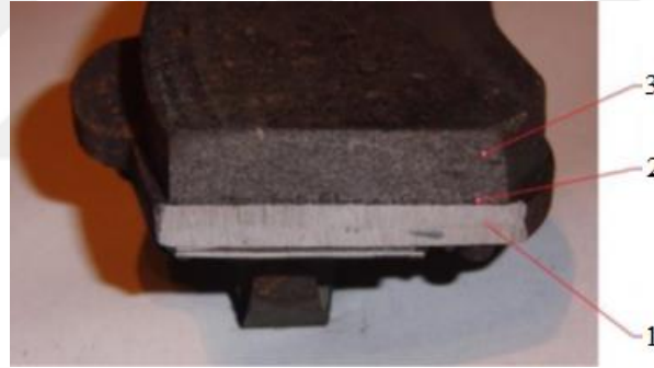
Şekil 2.2. Önemli fren balatası bileşenleri: 1- arka plaka, 2- alt katman, 3- sürtünme malzemesi (Borawski, 2020)
