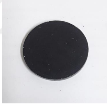
Şekil 3.6. Kütle azaltma katsayıları ölçümü için preslenmiş numune
