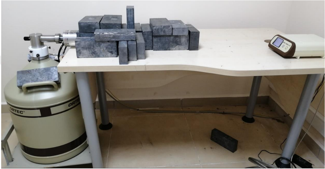
Şekil 3.1. Radyoaktivite ve radyasyon geçirgenlik ölçümlerinde kullanılan HPGe dedektör sistemi
