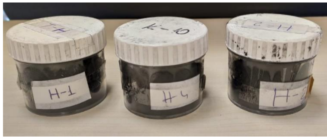
Şekil 3.3. Radyoaktivite ölçümleri için hazırlanan kuru pil örneklerinden bazıları
