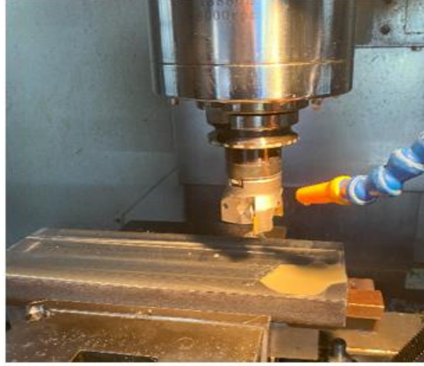
Şekil 3.3. Karbür Uçlu Tarama ile Yüzeyin Hazırlanması
