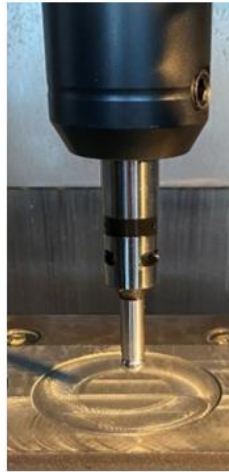
Şekil 3.8. Ses ve Işık Uyarılı Yüzey Sıfırlama Probu
