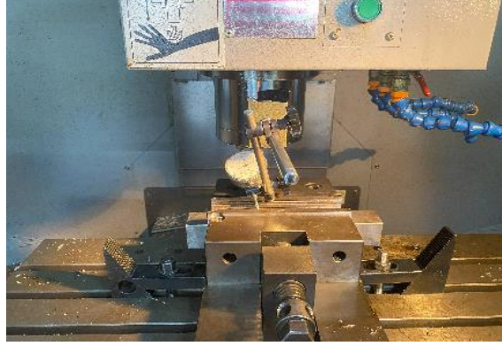
Şekil 3.9. Mengenenin Paralellięinin Komparatörle Ayarlanması
