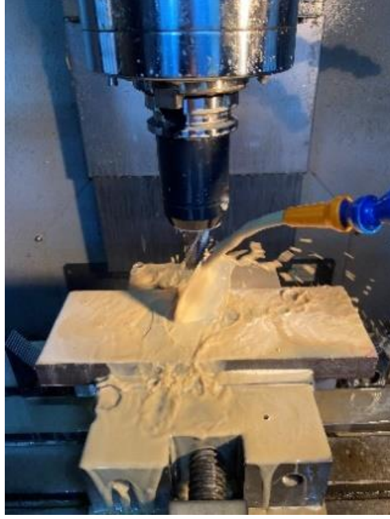
Şekil 3.12. Kesme İşlemi Sırasında Bor Yağının Kullanılması
