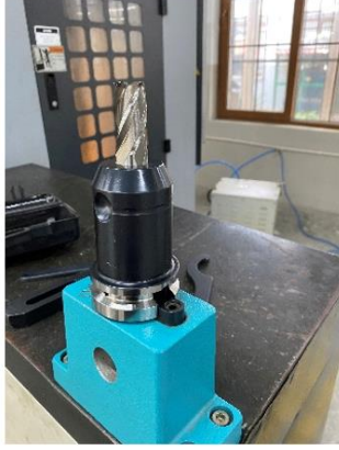
Şekil 3.1. HSS (High Steel Speed) Takım ile Cep Yüzeylerin İşlenmesi
