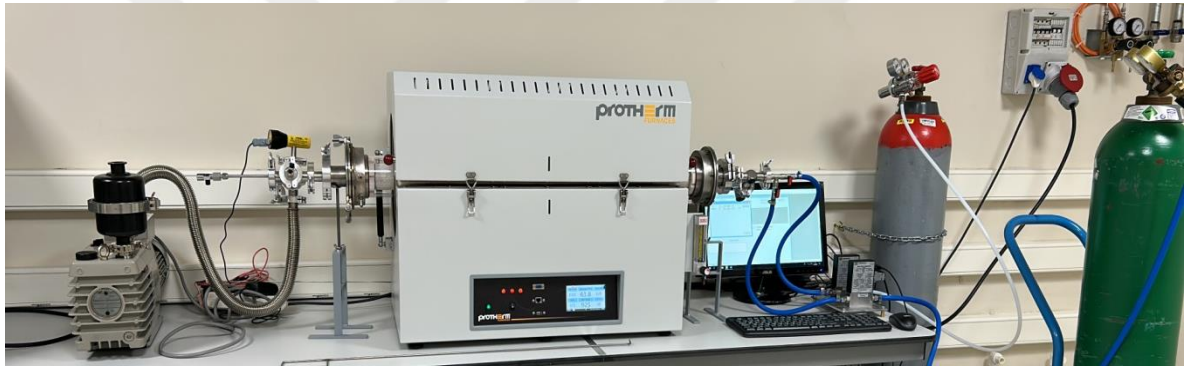
Şekil 3.1: CMS üretiminde kullanılan CVD sistemi (kütle akış kontrolörleri (MFC), split fırın ve vakum pompası).
