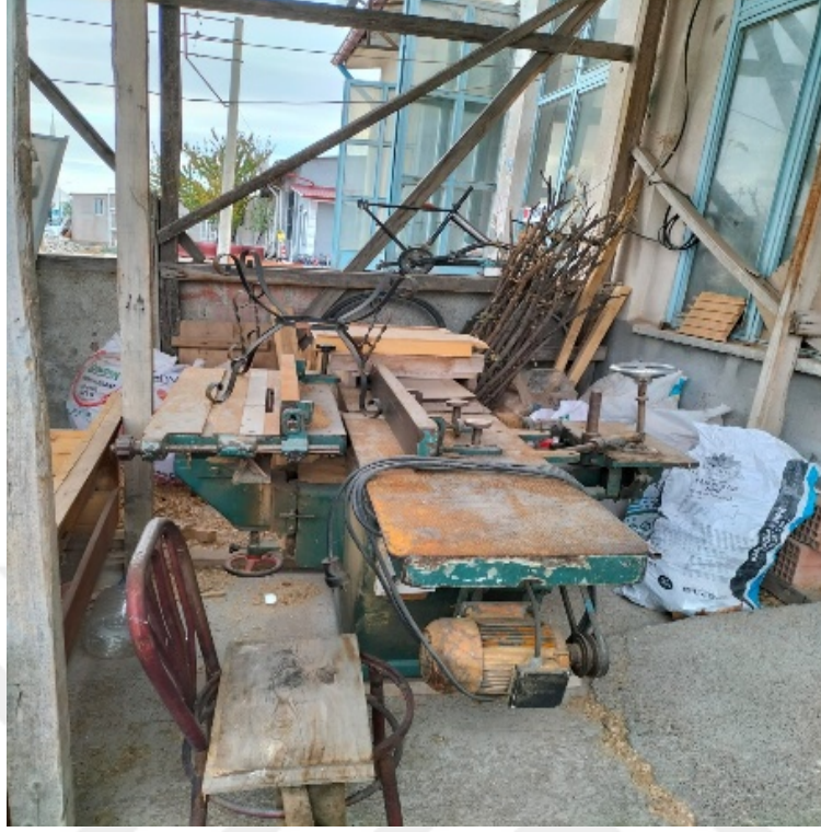
Fotoğraf 4.19. Hüseyin Koç'un Arı Kovanı Üretmek İçin Kullandığı Doğrama Makinesi
