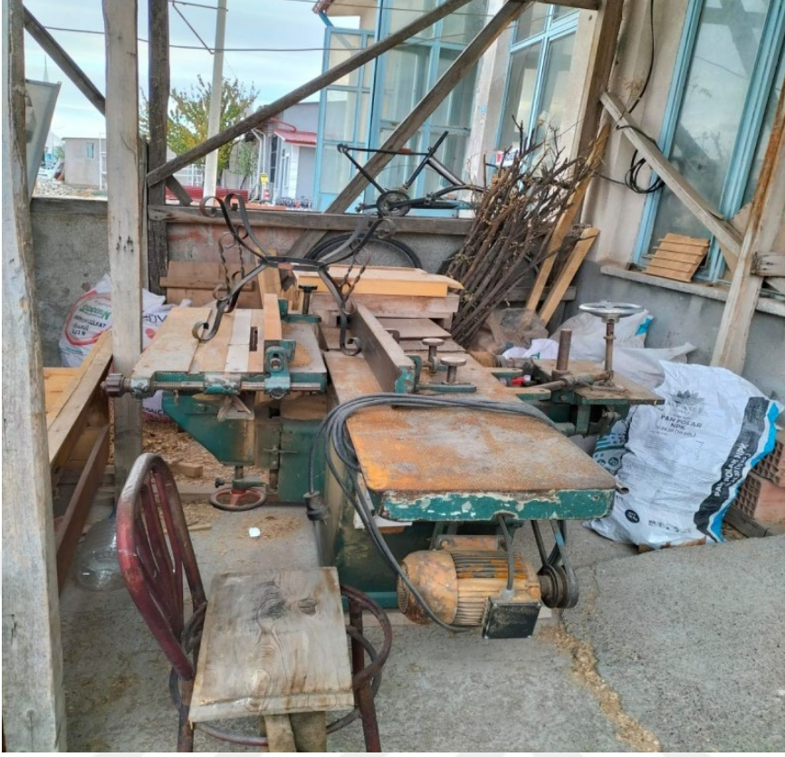
Fotoğraf 21: Kovan yapımında kullanılan doğrama makinesi
