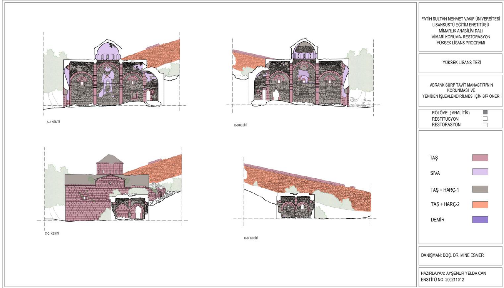
Şekil E. 27: Kilise kesitler malzeme analizi
