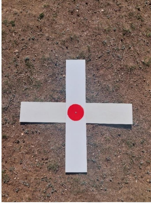
Şekil 2. 2: Çalışmada kullanılan yer kontrol noktalarından biri
