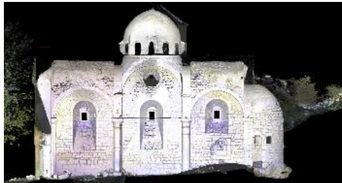
Şekil B.8: Kilise A-A kesiti lazer verisi ortofoto-1
