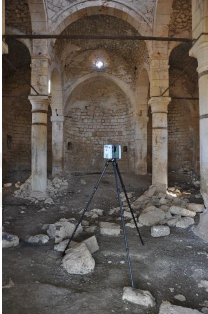
Şekil 2. 1:Kilise içerisinde yapılan yersel lazer tarama işlemi
