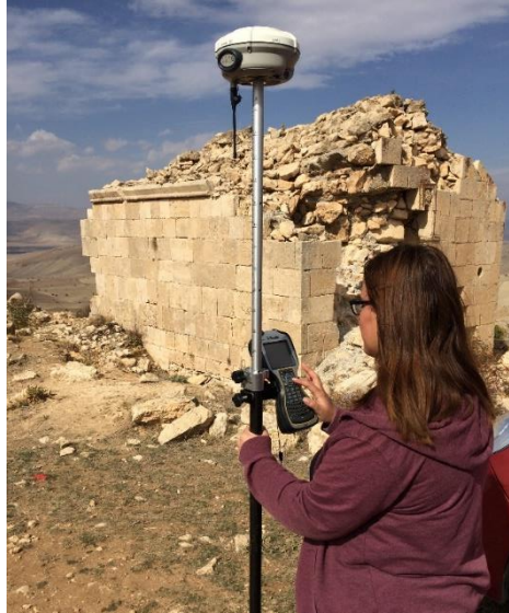
Şekil 2. 4: GNSS ayarlarının yapılması
