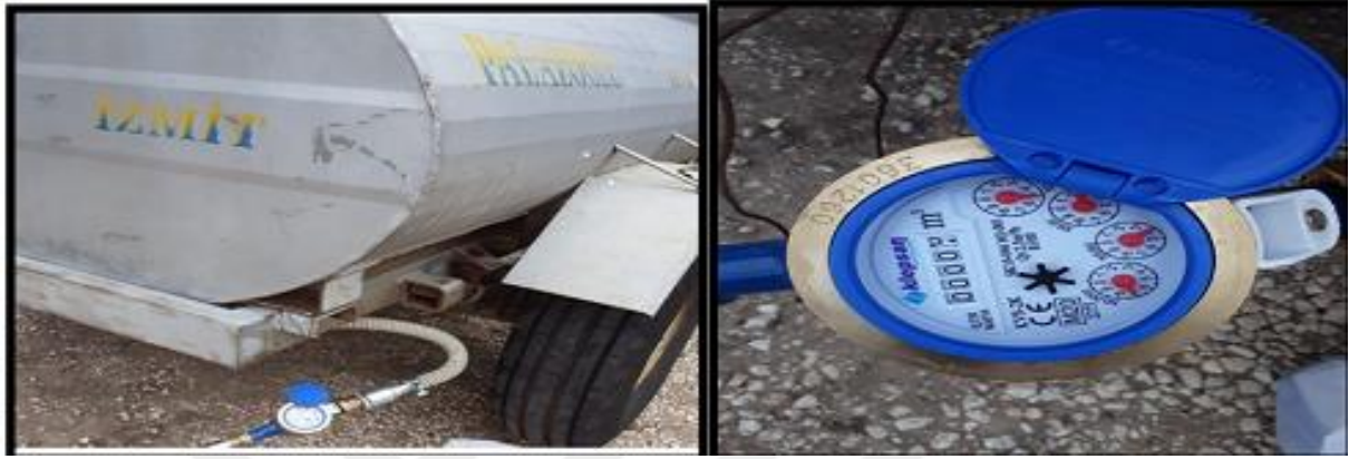
Şekil 2.3. Sulama tankeri ve monte edilmiş su sayacı
