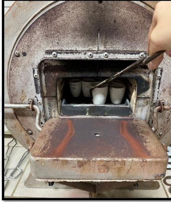
Şekil 3.7. 600 °C’lik kül fırınındaki numuneler
