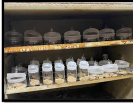
Şekil 2.7. Kurutmada kayıp testinde kullanılan etüvdeki keten tohumu numuneleri
