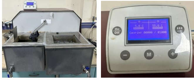
Şekil 2.19. Gruplara sıcaklık döngüsü ile yaşlandırma uygulaması yapılması
