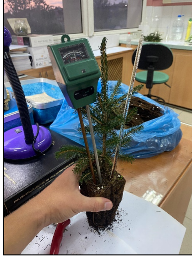
Şekil 6. Fidanlara ait toprak sıcaklık ve nem değerlerinin belirlenmesi
