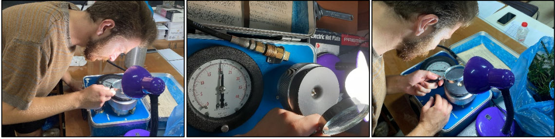
Şekil 5. Fidanlarda su potansiyelinin basınç odası tekniği ile ölçülmesi
