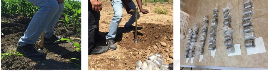
řekil 3.2. Toprak rneklemesi ve bozulmamıř rnekler
