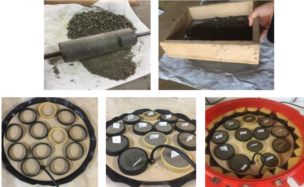
řekil 3.3. Toprak rneklere analiz hazırlanması ve solma noktası analizi
