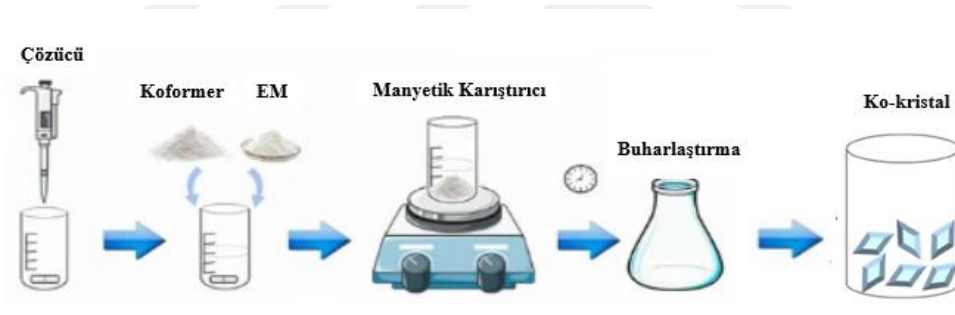
Şekil 2.9: Çözücü Buharlaştırma Yöntemi Şeması
