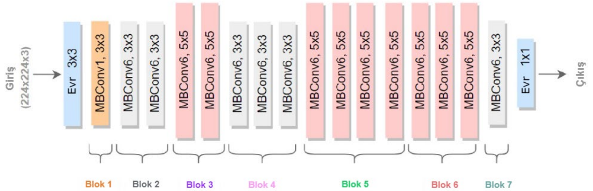
Şekil 2.25. EfficientNet-B0 mimarisinin blok diyagramı.
