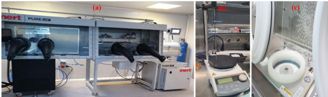
Fotoğraf 4.1. Deneyisel çalışmalarda kullanılan cihazlar (a) Eldivenli Kabin (Ar Akışlı), (b) Isıtıcı tabla, (c) dönel kaplama
