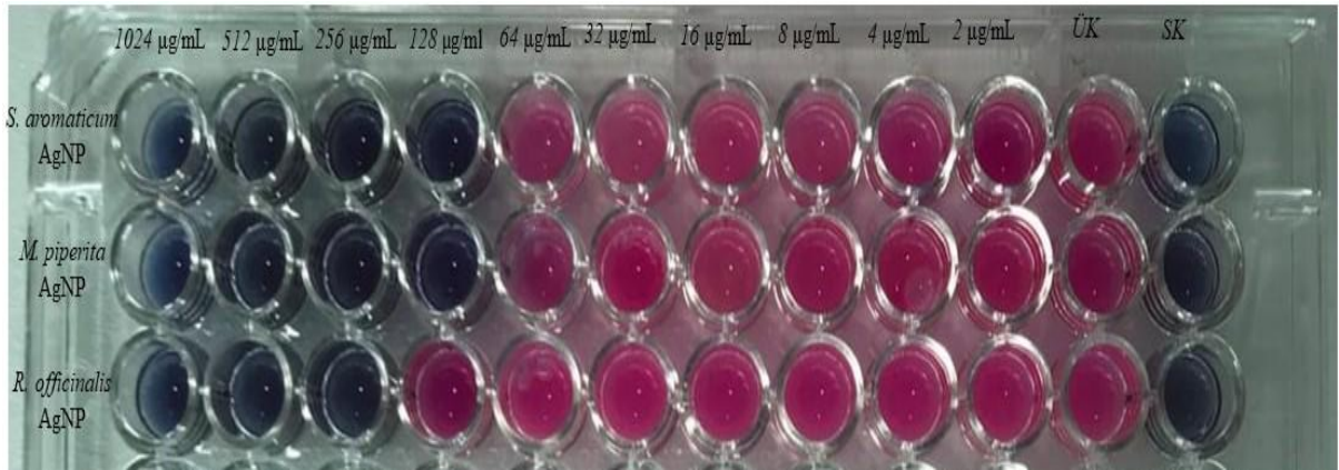
Şekil 4. 25. Örnek mikropılaka görüntüsü (ÜK; Üreme Kontrolü SK; Sterilite kontrolü)
