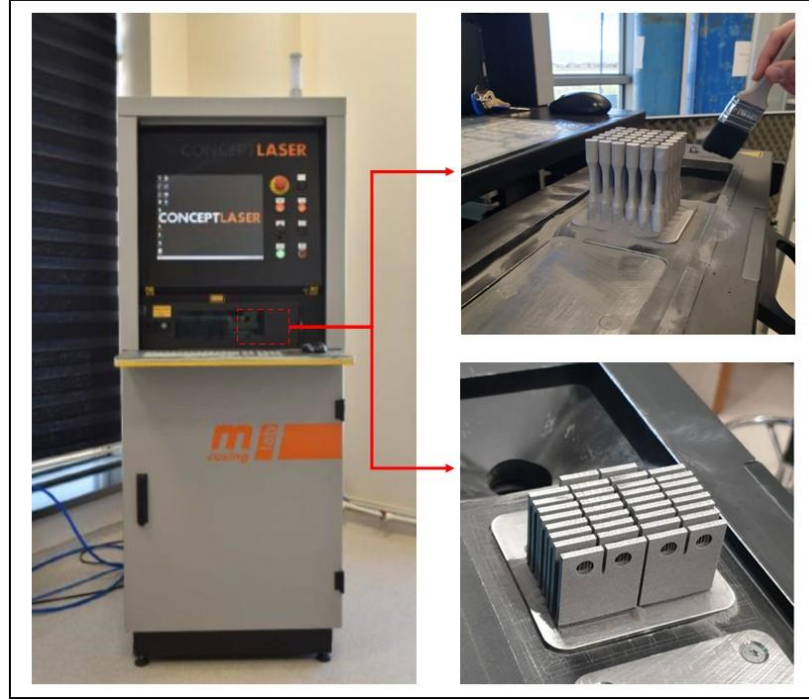
Şekil 3.6. Seçici Lazer Ergitme Cihazı ve üretilen numuneler
