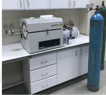
Şekil 3.7. Isıl işlem fırını ve gaz bağlantı sistemi
