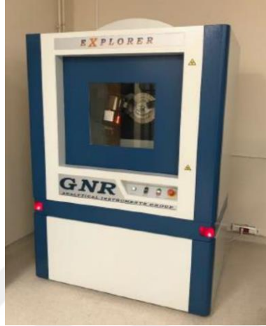
Şekil 3.15. GNR-Explorer marka model X ışını difraktometre (XRD) cihazı
