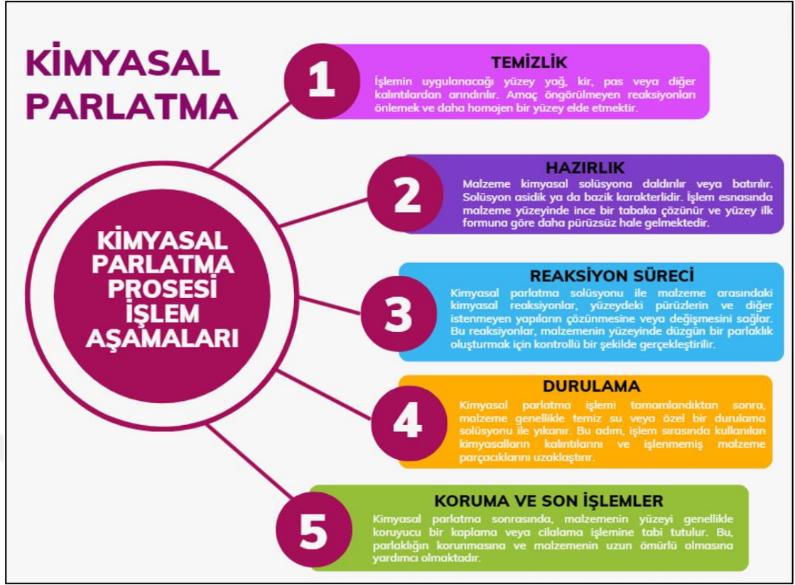
Şekil 1.21. Kimyasal parlatma prosesi işlem aşamaları
