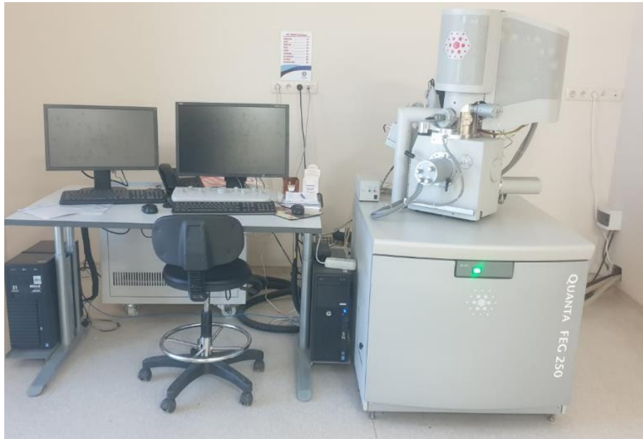
Şekil 3.19. FEG kaynaklı Taramalı Elektron Mikroskopu
