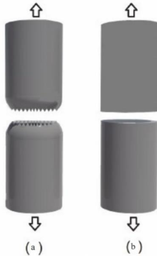
Şekil 3.5. a. Orta derece sünek malzeme kırılma mekanizması b. Gevrek malzeme kırılma mekanizması [31]
