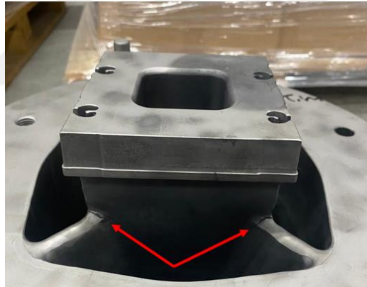
Şekil 4.3. Zıvana parçasının ayak kısmındaki çatlakları
