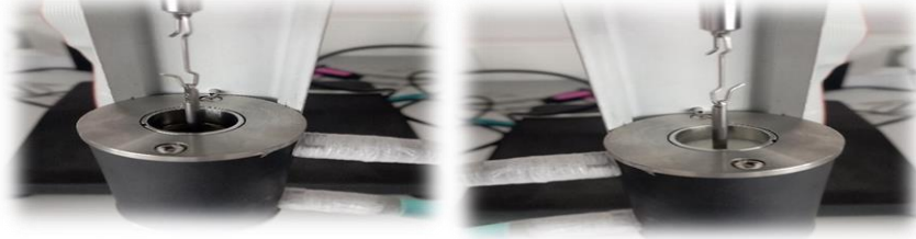
Şekil 3.5 Yağda ve emülsiyonda viskozite ölçümü
