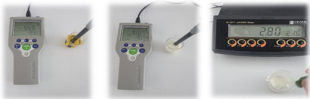
Şekil 3.4 Emülsiyon ve yağda pH ve iletkenlik tayini
