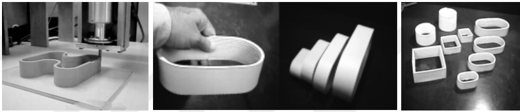
Şekil 2. 6 Seramik malzeme ile basılan cisimler (Khoshnevis vd., 2001)
