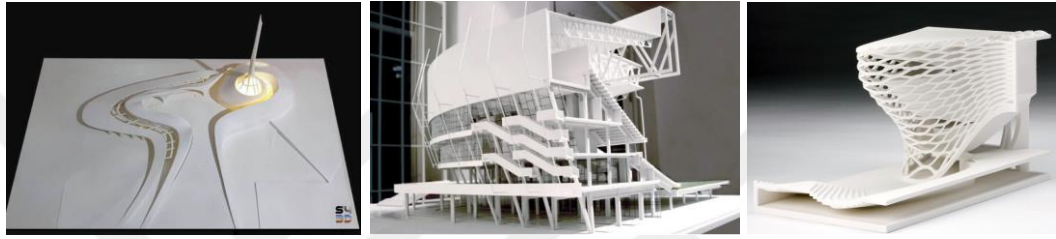
Şekil 2. 5 EÜ ile üretilmiş mimari maket örnekleri (S43D, b.t.; Dağ, 2020; 3D Baskı AI, 2022)
