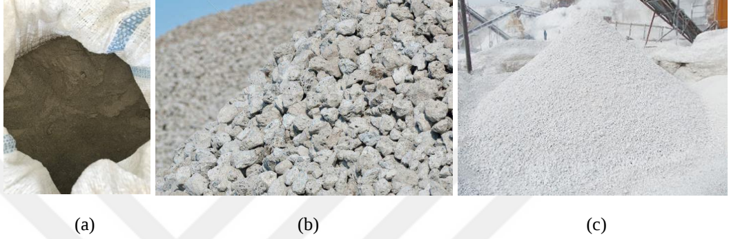
Şekil 3. 2 Uçucu kül (a) (Paköz, 2021) , yüksek fırın cürufu (b) (İnsapedia, 2019), mermer tozu (c) (Dönmez İnşaat, b.t.)
