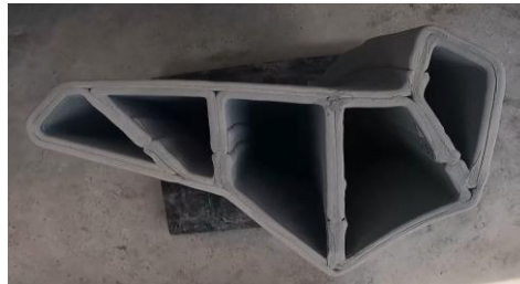
Şekil 4. 21 3BB beton blokların boşluklu yapısı (Block Research group, 2021a)
