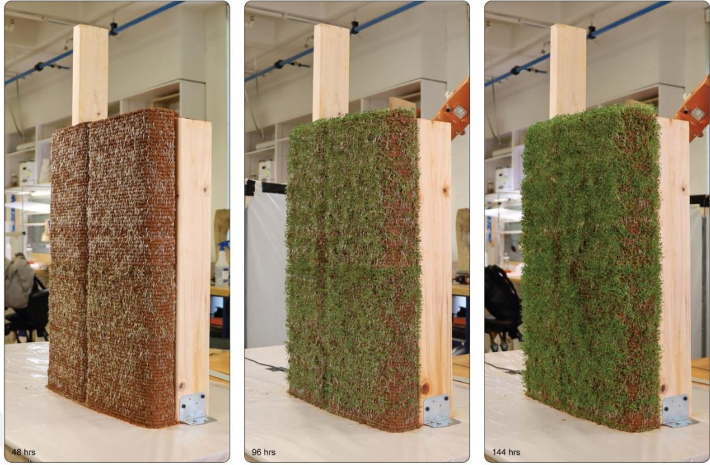
Şekil 3. 4 3BB ile toprak malzemeden üretilen duvarların yeşillenme süreci (Baharlou, 2022)
