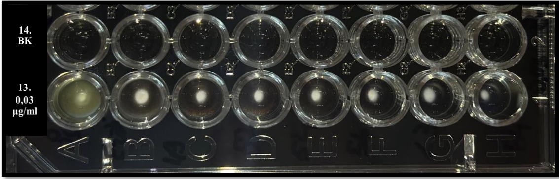
Resim 4.3 Demiri azaltılmış katyon ayarlı MHB besiyerinde sefiderokol mikrodilüsyon deneyinin örnek mikropalak görüntüsü.
