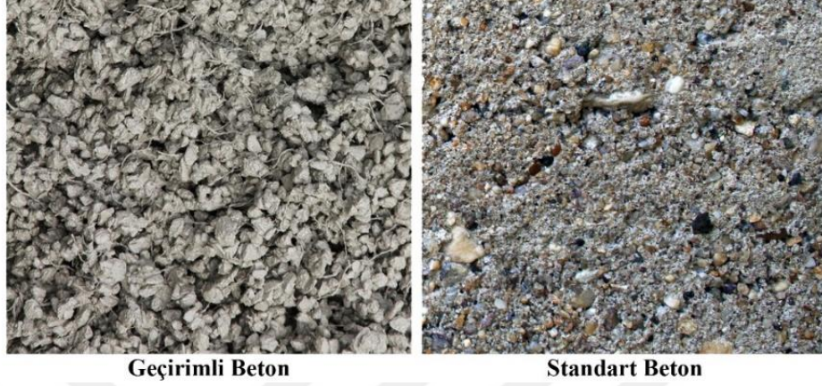
Şekil 2. 20 Geçirimli betonun standart betona karşı kesiti. Kaynak: Mazzuca, J. (2022, 5 Temmuz). What Is Pervious Concrete? Gambrick Construction. https://gambrick.com/what-is-pervious-concrete/ .
