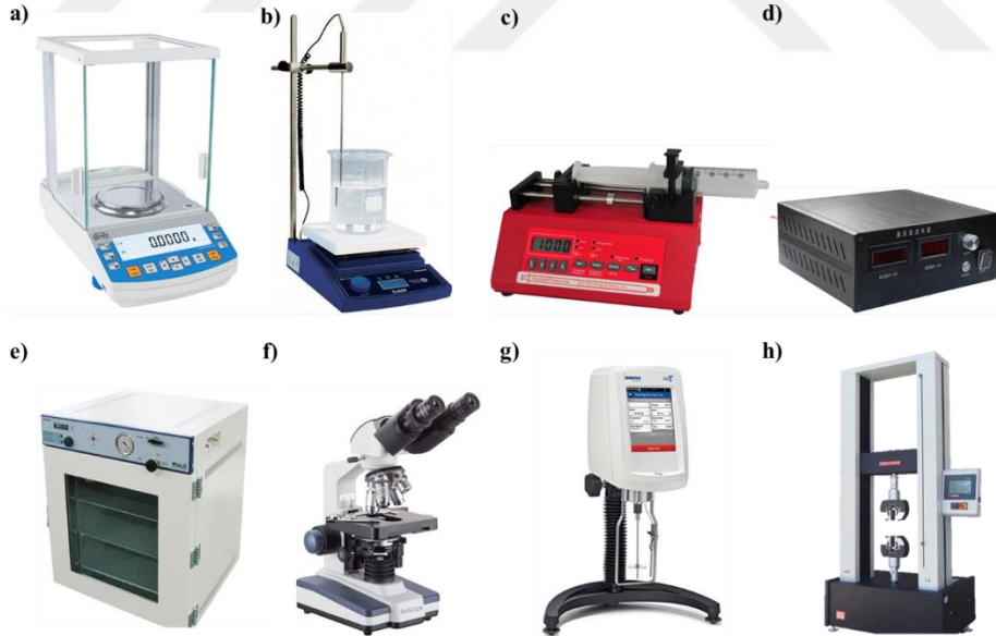
Şekil 4.3. Kullanılan bazı cihazlar a) hassas terazi, b) manyetik karıştırıcı, c) elektroeğirme pompa sistemi d) yüksek voltajlı güç kaynağı, e) vakum etüv, f) optik mikroskop, g) viskozimetre ve h) mekanik karakterizasyon cihazı
