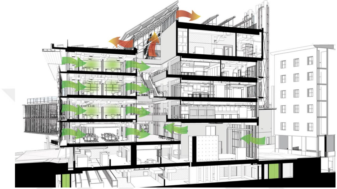
Şekil 3.29: Yapının havalandırma durumunu gösteren kesit (Url-31, 2024).
