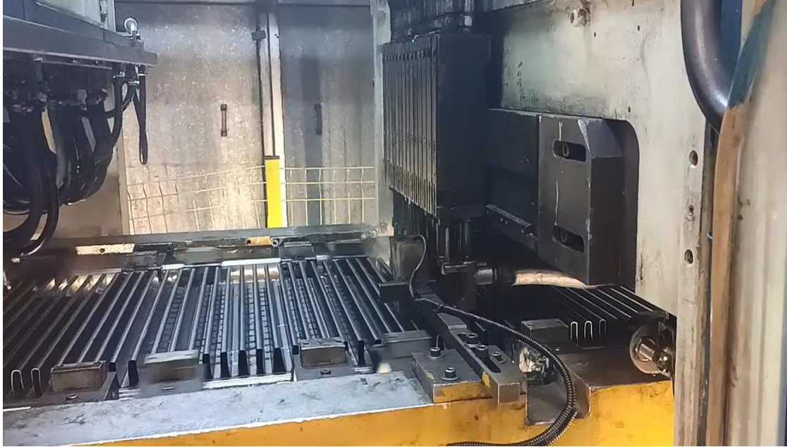
Şekil 2.6. Konvektör ile panel sacını punta kaynak ile birleştirme işlemi (DemirDöküm, 2014)
