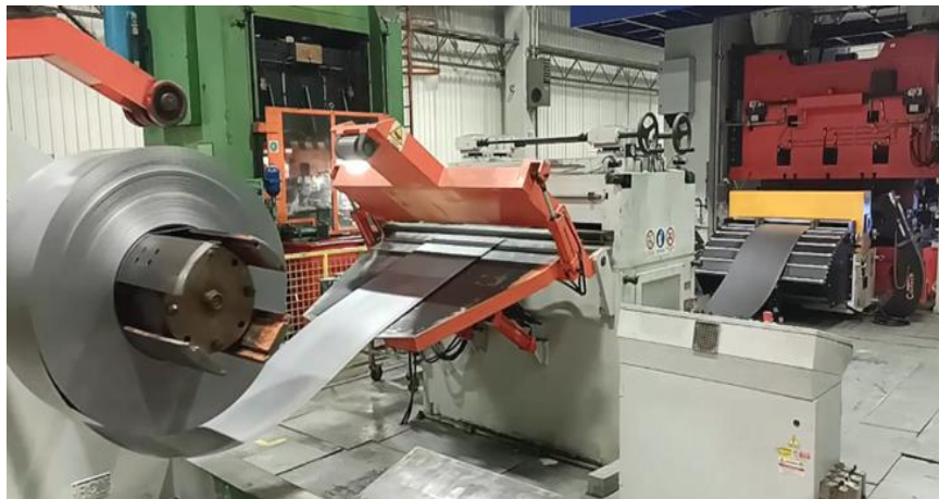
Şekil 2.4. Panel radyatör panel presi ve rulo açıcıya bağlanan sac rulosu (DemirDöküm, 2014)
