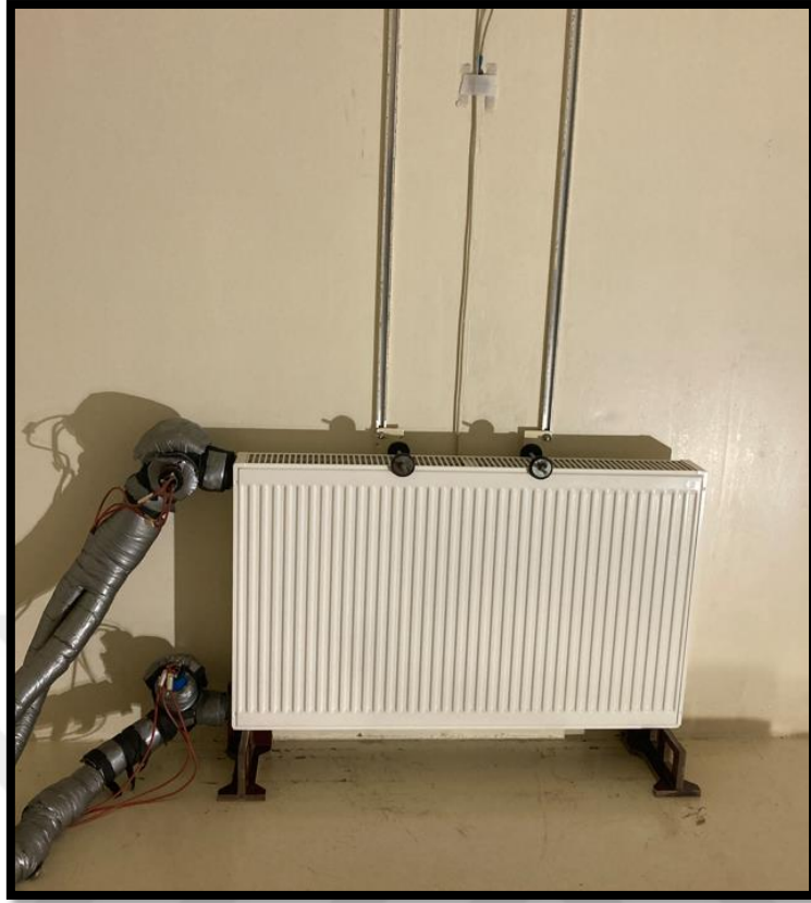
Şekil 4.3. EN 442’ye uygun hazırlanmış deneysel test düzeneği görseli
