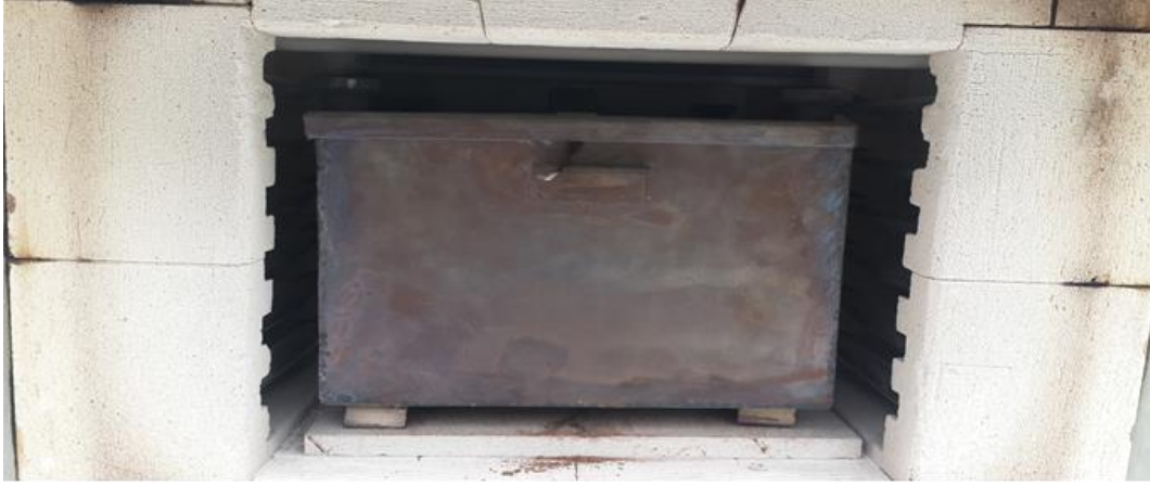
Şekil 3.2. Biyokömür üretimi için özel imal edilmiş kabın kül fırını içerisindeki görüntüsü
