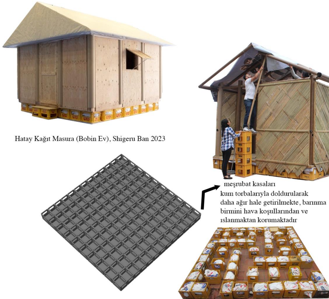
Şekil 98. Tez Çalışmasında Önerilen Acil Barınma Birimi İçin Su Basman Çözümü
