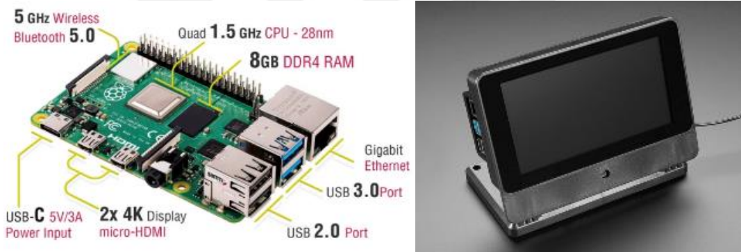
Şekil 20. Raspberry Pi 4 8G mikro kart bilgisayar ve Raspberry Pi 7" Smarti Pi Touch Pro
